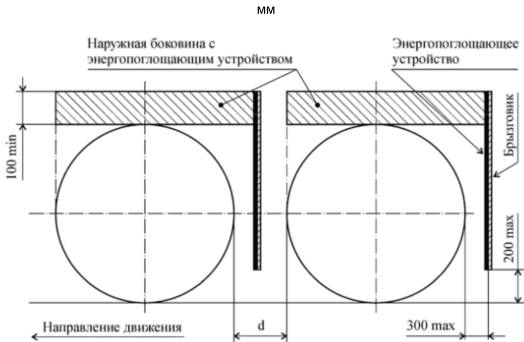
Рисунок 9.4. Схема системы защиты от разбрызгивания с энергопоглощающими устройствами для осей с неуправляемыми и самоустанавливающимися колесами
